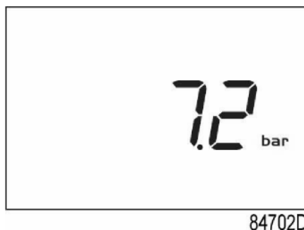
Главный экран с давлением (остановлен компрессор)
