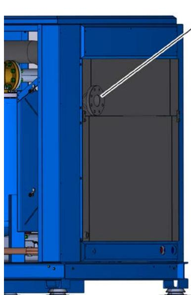
1 Сжатый компрессором воздух после фильтрации поступает на штуцер для сжатого воздуха (Рис. 22/1) для последующей подачи в сеть сжатого воздуха.
