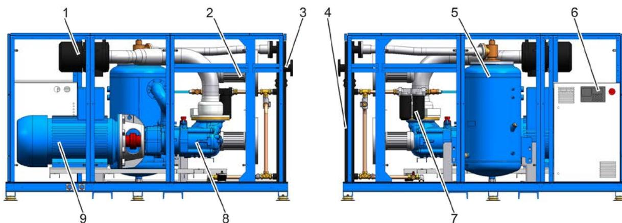
Рис. 11: Сторона подвода давления слева, сторона распределительного шкафа справа
