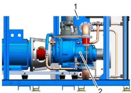
Впускаемый воздух сжимается ступенью компрессора (Рис. 15/2) и вместе с впрыскиваемой охлаждающей жидкостью поступает в бак высокого давления для охлаждающей жидкости (Рис. 15/1).
