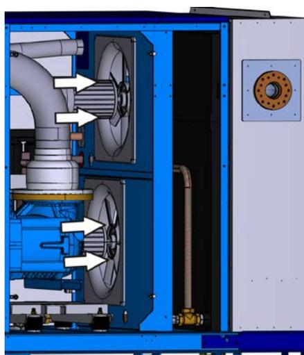
Охлаждающий вентилятор подает приточный воздух к приемному фильтру, а также служит для технологического охлаждения. Приемный фильтр фильтрует приточный воздух и подводит его к компрессору для сжатия.
