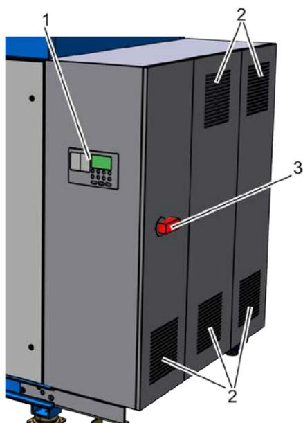
В распределительном шкафу размещается электрооборудование. Снаружи на распределительном шкафу находятся главный выключатель или аварийный выключатель (Рис. 12/3) и система управления (Рис. 12/1) машины. Открывать распределительный шкаф при помощи входящего в комплект поставки ключа с двойной бородкой разрешается только квалифицированным электрикам. Вентиляторы распределительного шкафа (Рис. 12/2) обеспечивают постоянный воздухообмен внутри распределительного шкафа.
